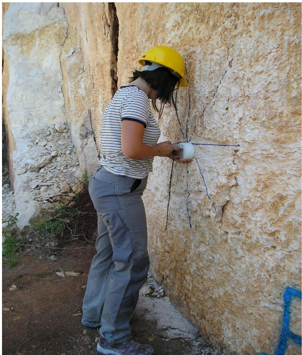
Slika 5-3 Primjer mjerena orijentacija pomoću kružne ploče.
