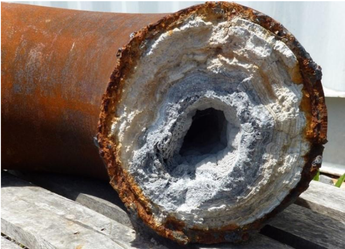
Slika 3-7. Kamenac nastao od silicijevog dioksida (www.mmu.ac.uk, 2019)
