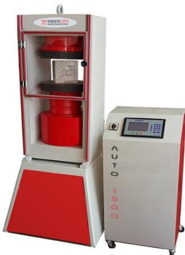
**Slika 5-1.** Hidraulična preša za ispitivanje tlačne čvrstoće (<http://www.testmak.com>)
