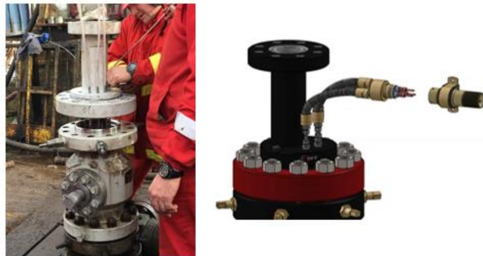
**Slika 4-24.** Pokrovna prirubnica i trožilni kabel (INA d.d., 2019)
