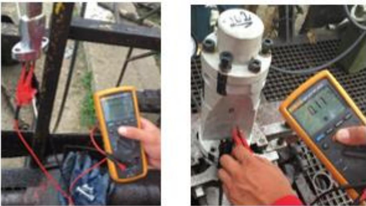
**Slika 4-7.** Prikaz mjerenja otpora spojnica kabela i utora za spoj s kabelom na glavi motora (INA d.d., 2019)
