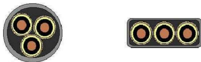
**Slika 2-18.** Prikaz presjeka kabela kružnog i prstenastog oblika (Shell, 2000)
