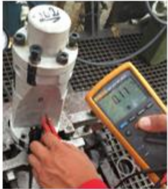
Slika 4-7. Prikaz mjerenja otpora spojnice kabela i utora za spoj s kablom na glavi motora (INA d.d., 2019)
