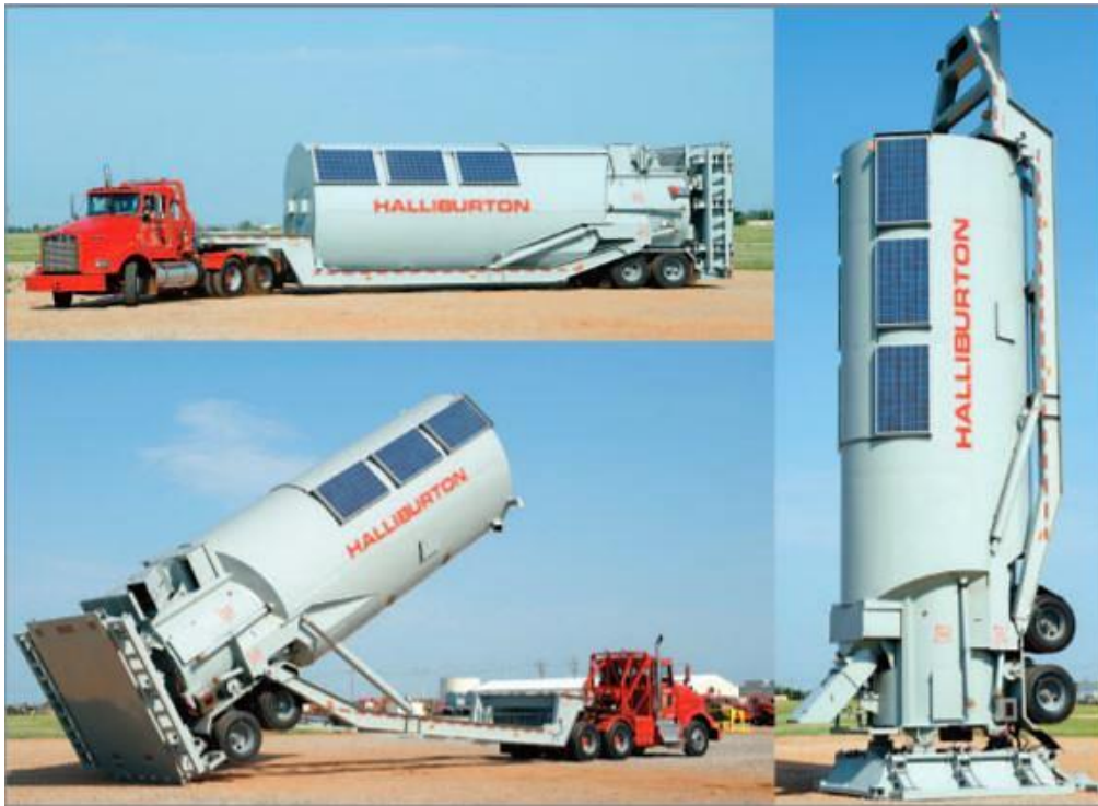
Slika 5-5. SandCastle PS-2500, vertikalni silos (www.halliburton, 2020)
