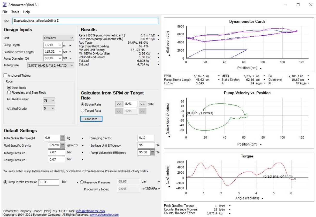
Slika 4-11. Usporedba predviđenih i mjenjenih podataka sustava na eksploatacijskoj naftnoj bušotini Z
