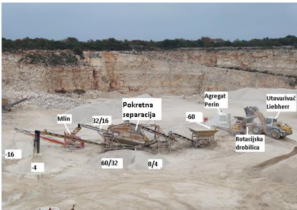
Slika 4-6 Oplemenjivačko postrojenje spojeno u niz
