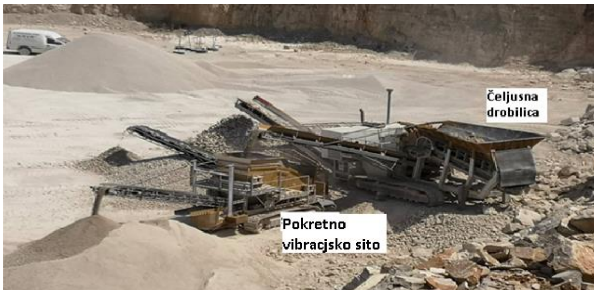
Slika 3-4 Zajednički rad čeljusne drobilice i pokretnog vibracijskog sita
