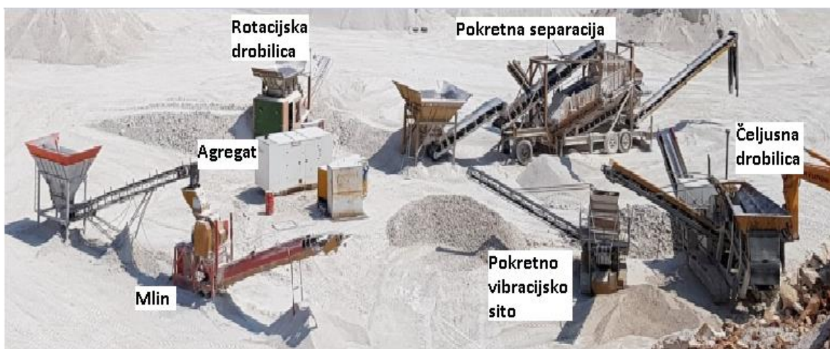
Slika 4-2 Postojeći razmještaj mobilnog oplemenjivačkog postrojenja
