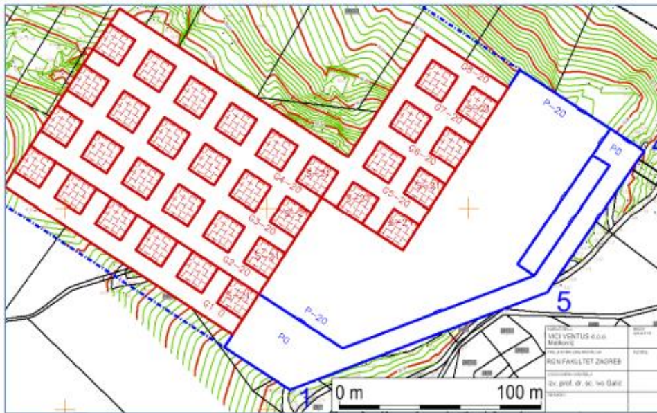
Slika 3-2 Završno stanje razvoja podzemnog kopa u prvoj varijanti (Galić i dr., 2020)
