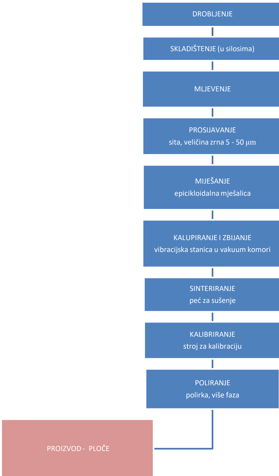
Slika 5-2 Proces proizvodnje ploča od umjetnog kamena
