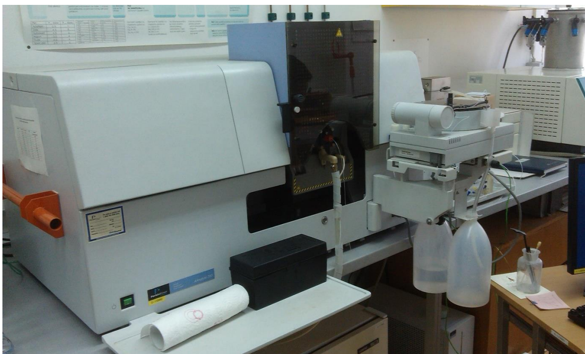
Slika 4.9. Atomski spektrometar PerkinsElmer AAnalyst 700 (foto: Dražen Tumara)
