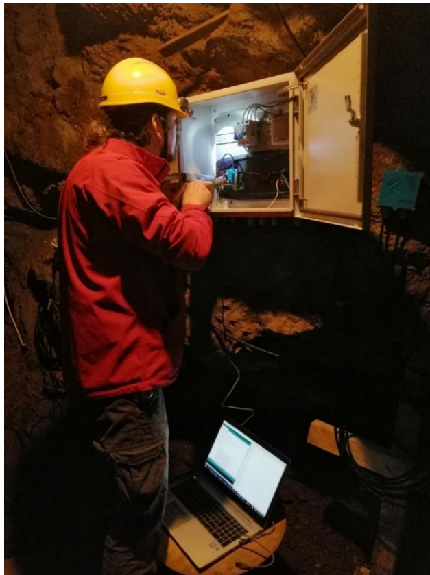
Slika 3-12. Spajanje senzora za mjerenje temperature i vlažnosti
