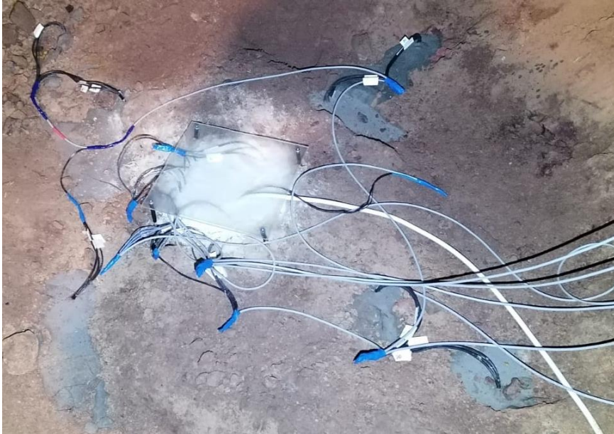
Slika 3-11. Centralna bušotina prije spajanja struje na grijač
