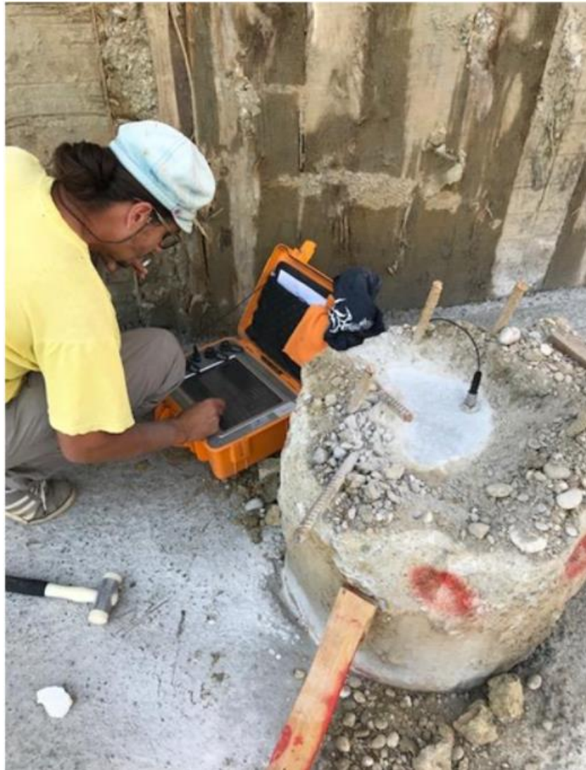
Slika 4-1 Uređaj za seizmičko ispitivanje pilota
