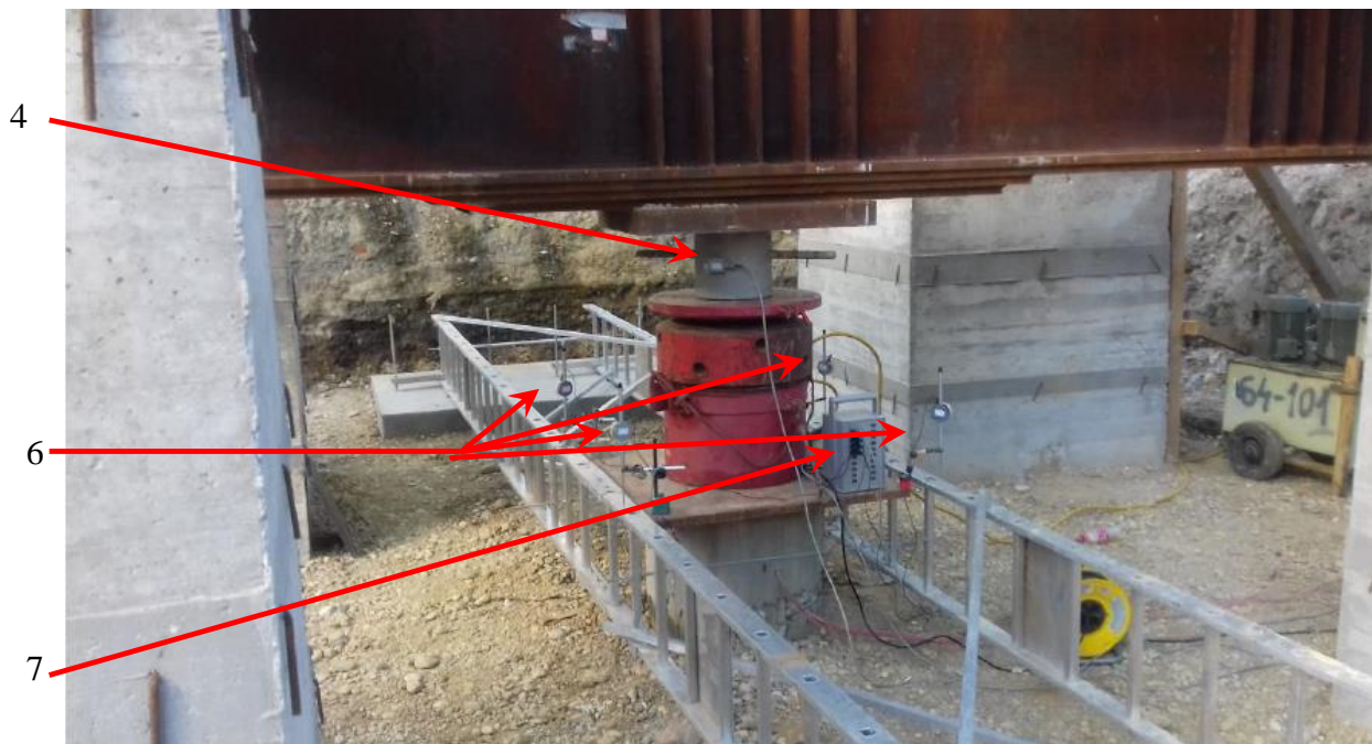
Slika 7-2 Glava pilota, hidraulička preša, pretvornik sile i digitalni mjerači pomaka
