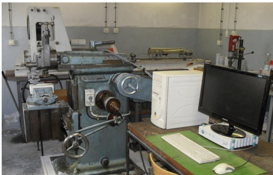
Slika 5. Uređaj za pravolinijsko rezanje stijena (Korman, 2014)
