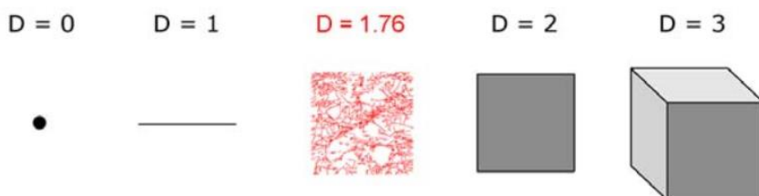
Slika 3-10. Fraktalne dimenzije topoloških objekata sa cjelobrojnim fraktalnim dimenzijama i primjer fraktalnog sustava pukotina s dimenzijom D=1,76 (preuzeto iz Verbovšek, 2009).
