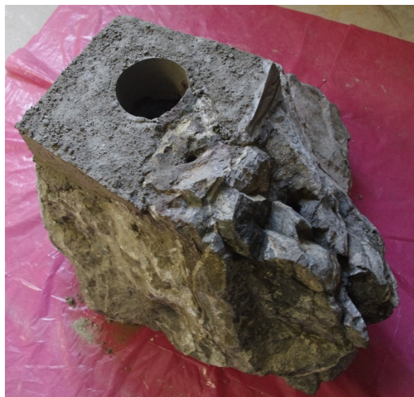
Slika 5-7. Uzorak stijene s betonom dodanim radi korekcije oblika glavne bušotine
