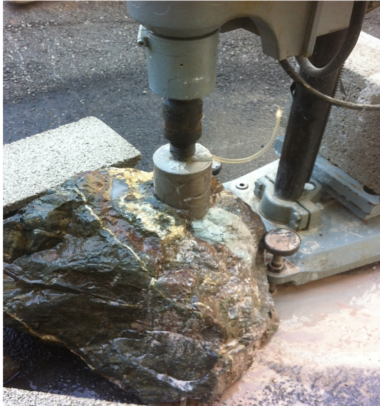
Slika 5-2. Bušenje glavne bušotine
