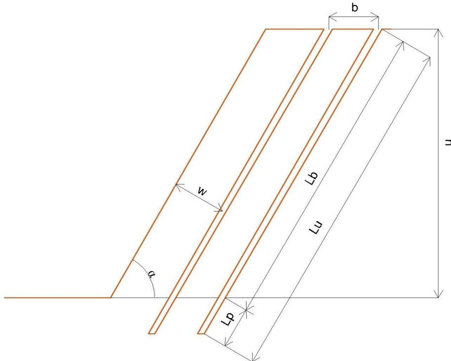
Slika 3.7. Shema presjeka minskih bušotina A-A'
