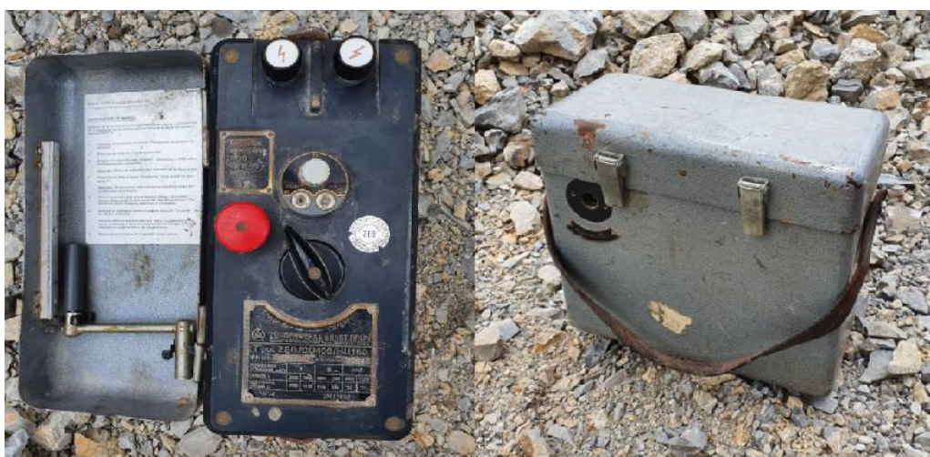
Slika 3.14. Kondenzatorski stroj za paljenje mina
