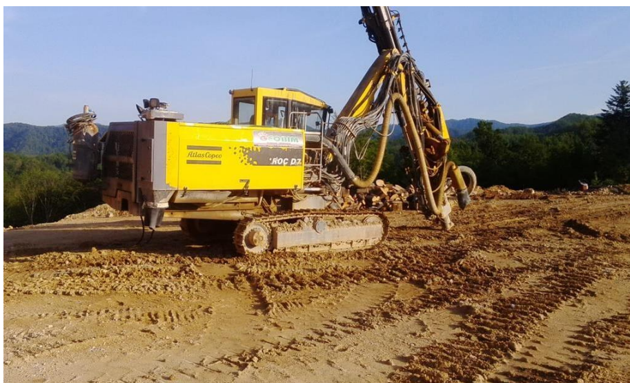
Slika 3.3. Bušilica s vanjskim čekićem Atlas Copco ROC D7 (Herceg, 2015)
