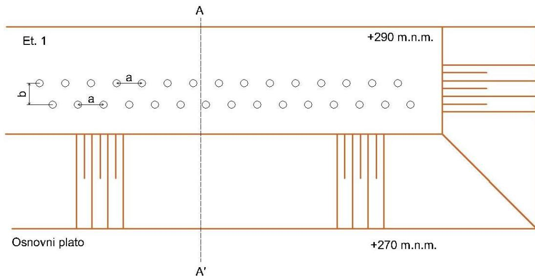
Slika 3.6. Shema minskih bušotina na razvijenim etažama
