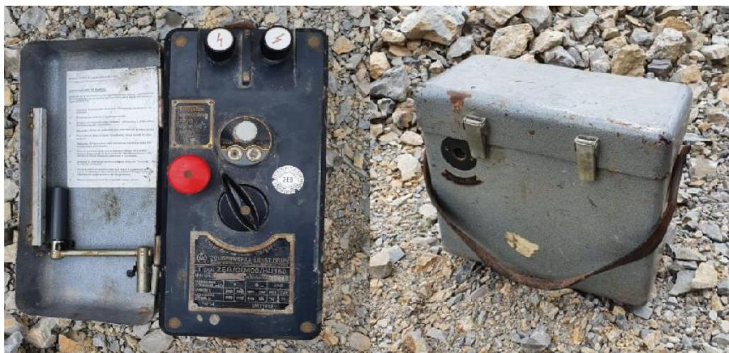
Slika 3.14. Kondenzatorski stroj za paljenje mina
