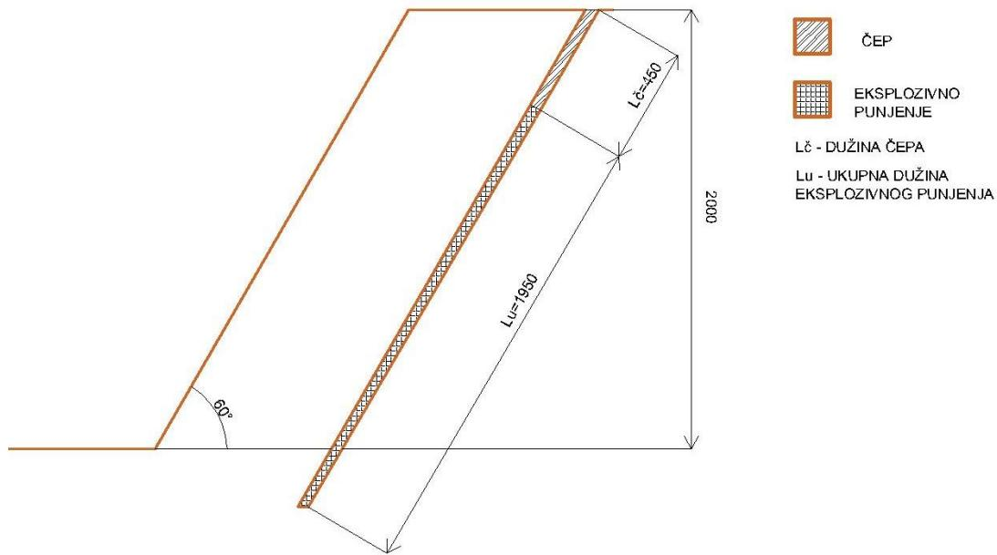
Slika 3.11. Konstrukcija minskog bušotina
