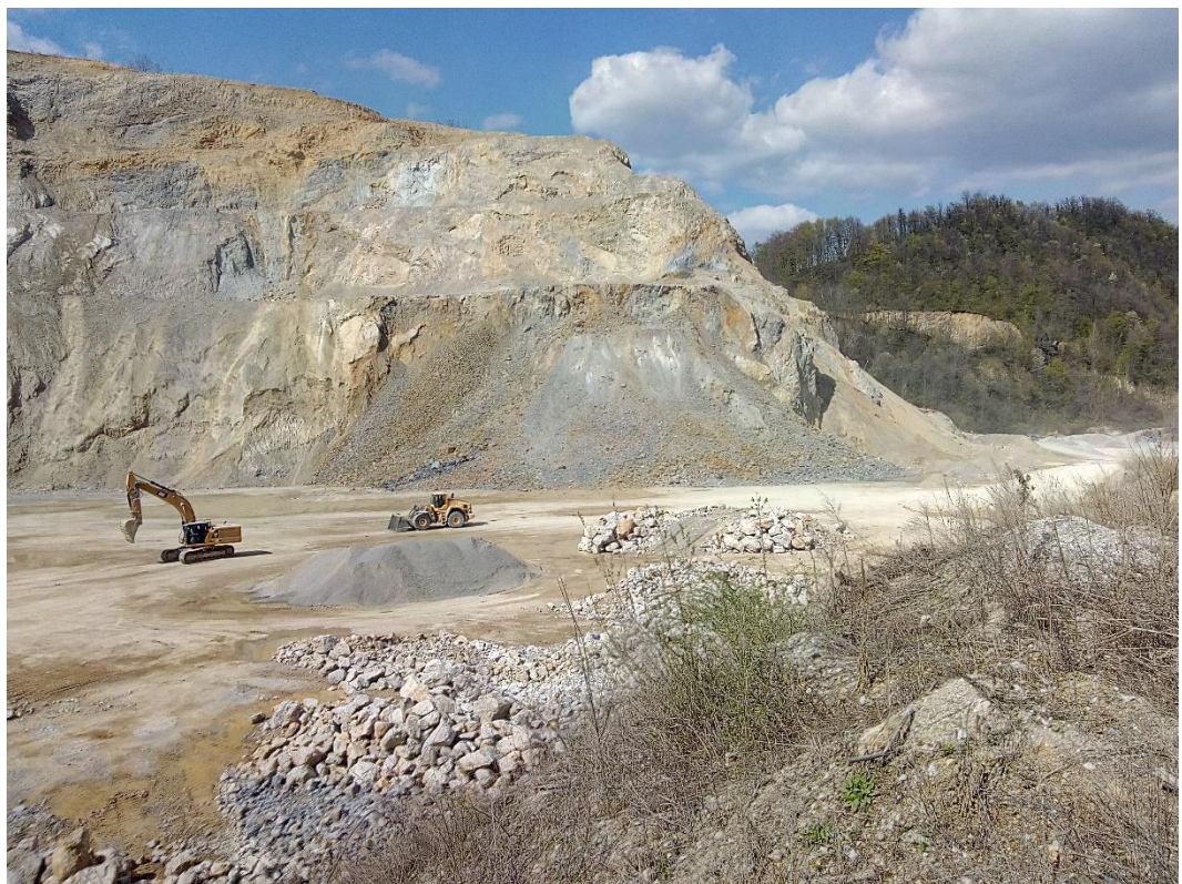
Slika 3.16. Etaža na eksploatacijskom polju "LOVNO-LOVNO 2" poslije miniranja
