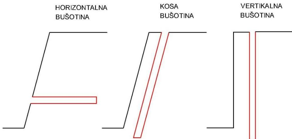
Slika 3.2. Shema horizontalne, kose i vertikalne bušotine
