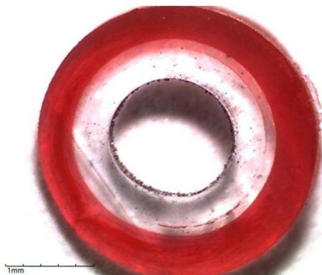
Slika 2-11 Poprečni presjek udarne cjevčice (Fabien, 2017)
