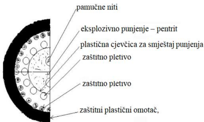
Slika 2-5 Presjek detonirajućeg štapina (Sharma, 2008)
