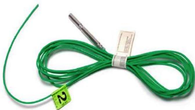
**Slika 2-14** Detonator sustava iniciranja niskoenergetskim štapinom (Dobrilović, 2008)
