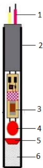
Slika 2-13 Prikaz elektroničkog detonatora(Rock Products News, 2021)
