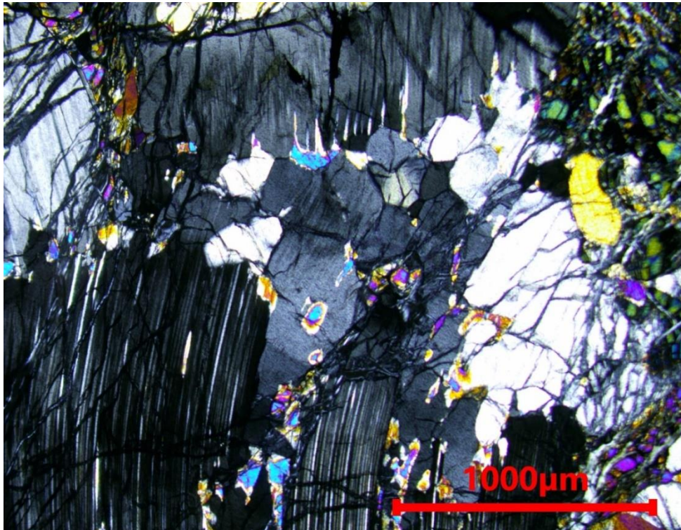
Slika 5.28. Deformirani porfiroklast ortopiroksena s neblastima koji pokazuju undulozno potamnjenje. Uzorak spinelskog lercolita Zub-4, (N+).
