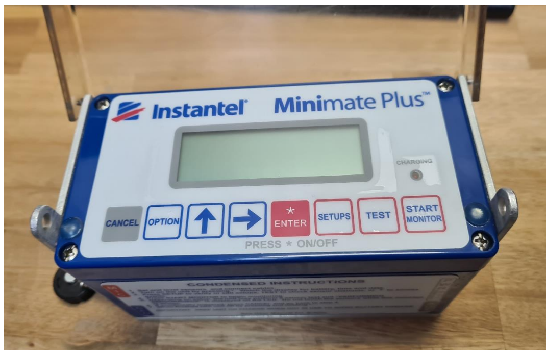
Slika 6-4 Instrument za mjerenje brzina oscilacija tla InstanTEL Minimate Plus
