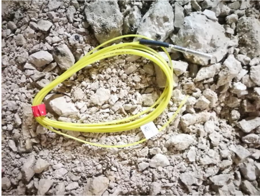
Slika 5.3-3 Neelektrični detonator s udarnom cjevčicom
