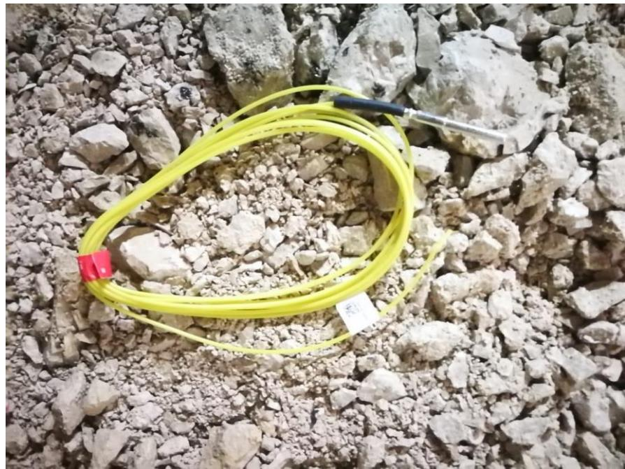
**Slika 5.3-3** Neelektrični detonator s udarnom cjevčicom
