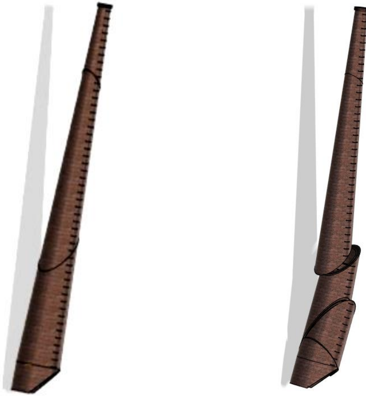
Slika 5-1-5. Model izrade vlačnih pukotina dimnjaka pri padu (vlastiti model)
