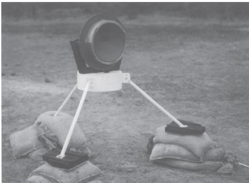
Slika 6-26 Prikaz uređaja za rušenje - EFP promjera 300 mm (fotografiju omogućena od strane Organizacije za znanost i tehnologiju obrane, Australija) (Weickert, 1998)
