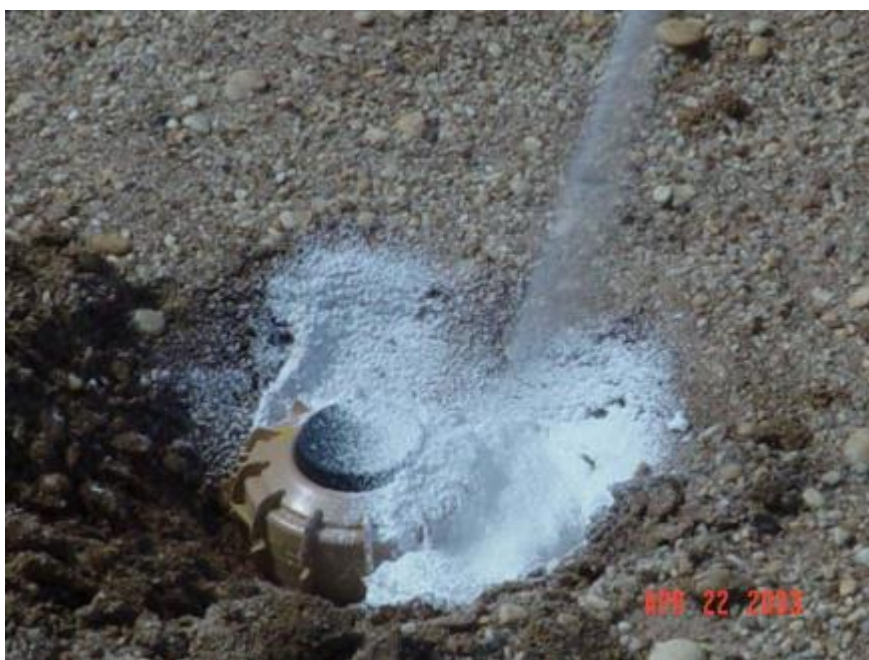
Slika 6-37 Neutralizacija VS-50 mine pomoću pjene nitrometana (US Army Night Vision and Electronic Sensors Directorate (NVESD), 2003)
