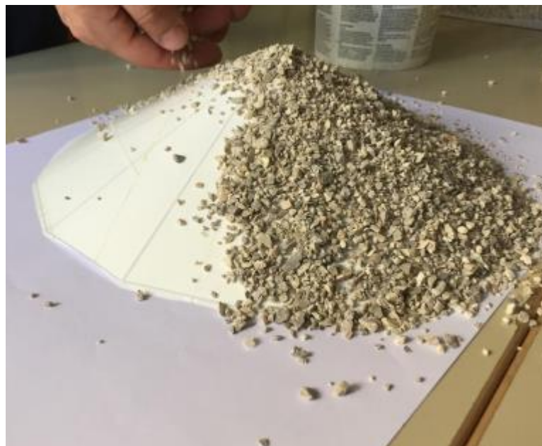
Slika 4-4 Posipanje granuliranog materijala na plašt stošca (Kostrić, 2018)
