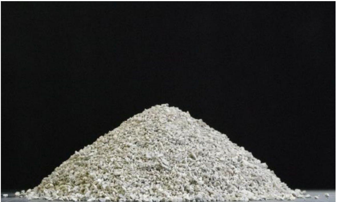
Slika 4-2 Dolomitni uzorak frakcije 2/4 mm
