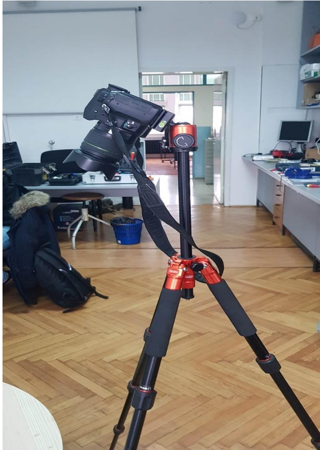
Slika 4-7 Položaj kamere pod kutem od 60°
