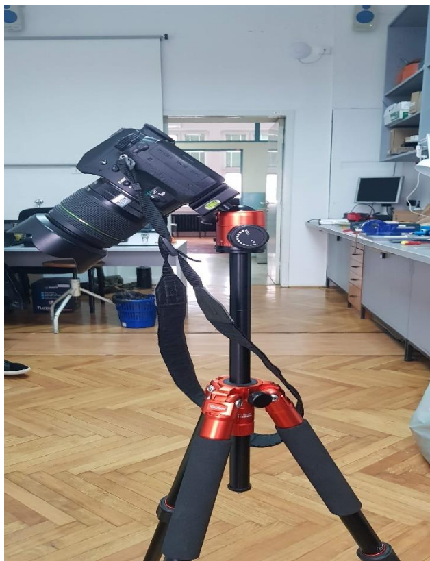
Slika 4-6 Položaj kamere pod kutem od 45°
