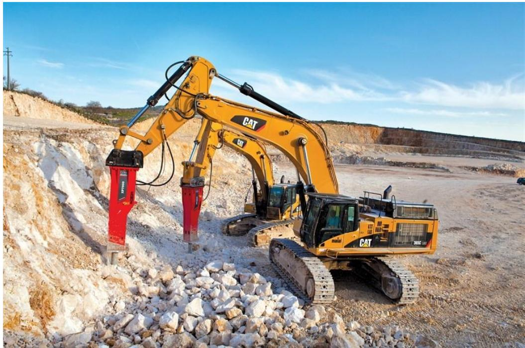
Slika 1-1. Hidraulični čekići u kamenolomu (Iskop hidrauličnim čekićem, 2013.)
