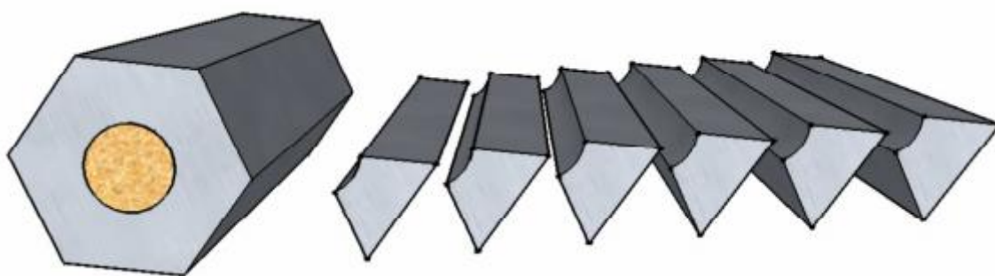
Slika 3-5. Fragmentacija šesterokutne prizme s provrtom napunjenim eksplozivom (Bohanek i sur., 2013)
