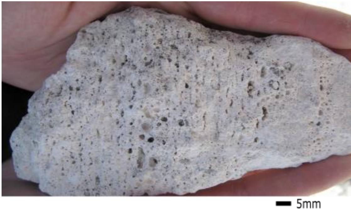
Slika 2.3. Makroskopski prikaz cjevastih fenestri, preuzeto iz USGS (2010)
