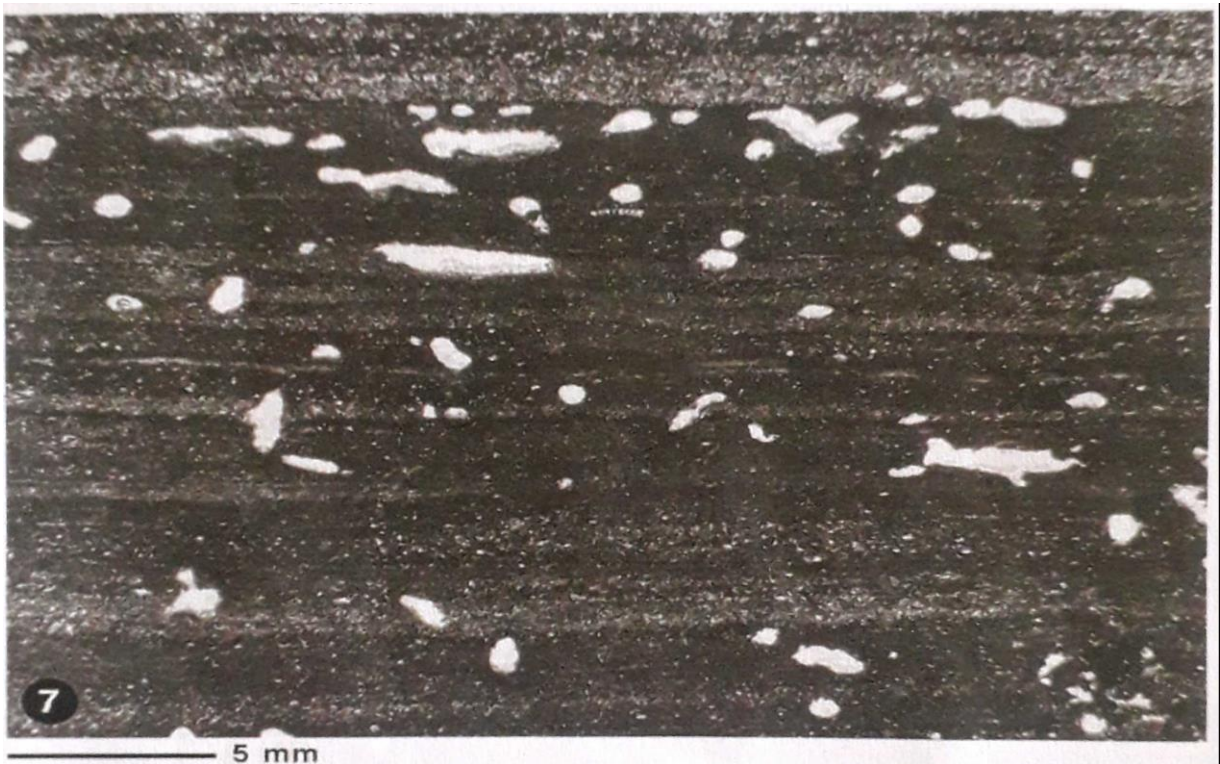
Slika 2.7. Struktura ptičjega oka u laminiranom dolomitnom madstonu, preuzeto iz Flügel (2004)
