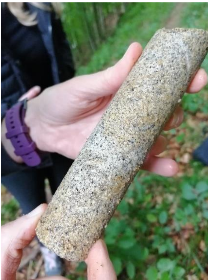
Slika 18: Jezgra gnajsnog sastava dobivena bušenjem (foto: Brcković, 2021).
