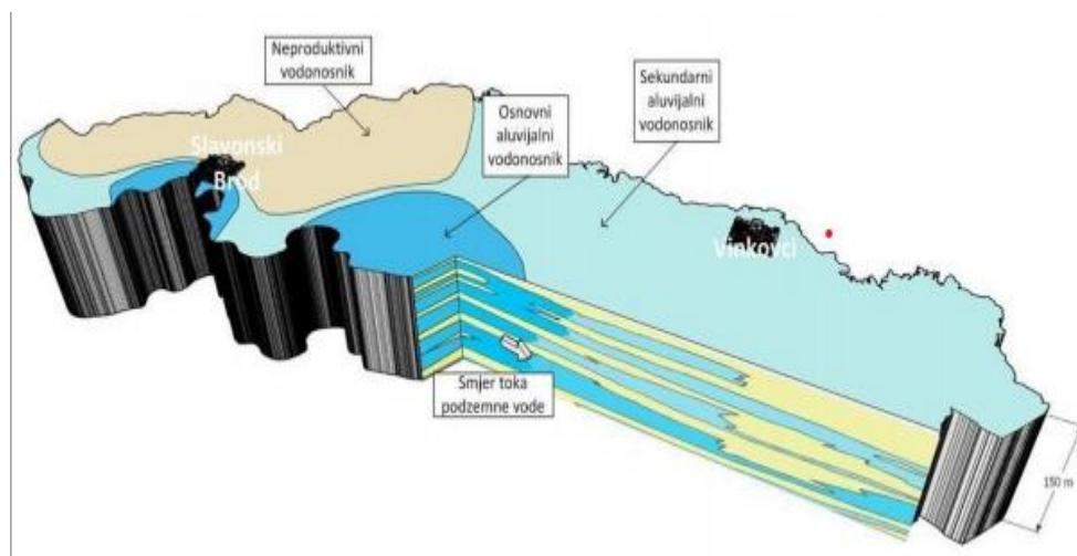
**Slika 3-2.** Konceptualni model vodonosnog sustava u savskom dijelu istočne Slavonije (prema Nakić et al., 2018.)
