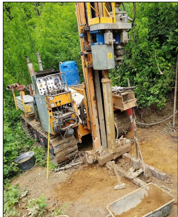
Slika 5-1. Stroj za bušotine Casagrande C6. Slika 5-2. Stroj za bušotine Geotech 604.
