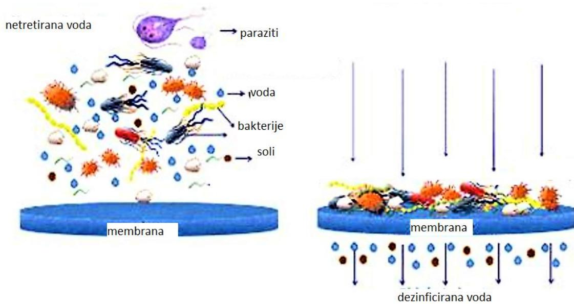
Slika 6.3. Dezinfekcija vode pomoću membrane ([www.sswm.info/membrane-filtration](http://www.sswm.info/membrane-filtration))
