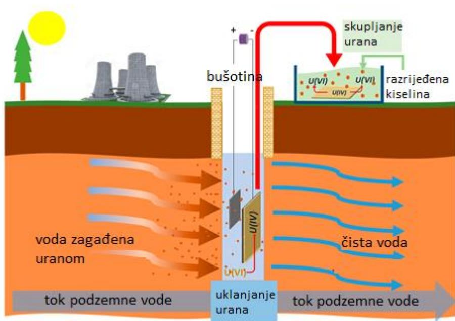
Slika 2.4. Uklanjanje urana iz podzemne vode pomoću titanske elektrode
