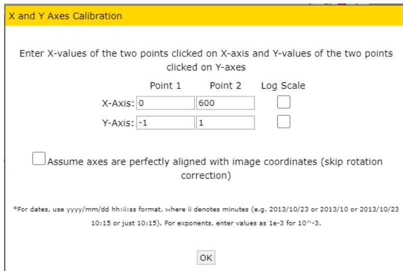
**Slika 3-4.** Navođenje vrijednosti podataka na odabranim kalibracijskim točkama
