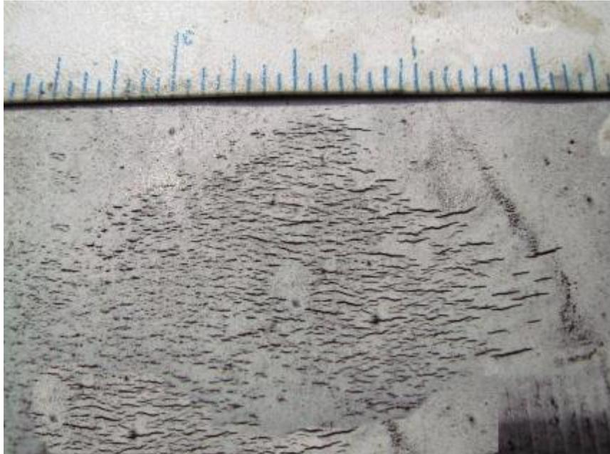
**Slika 3-1.** Serija pukotina uslijed korozije (Tomar et al., 2008)
