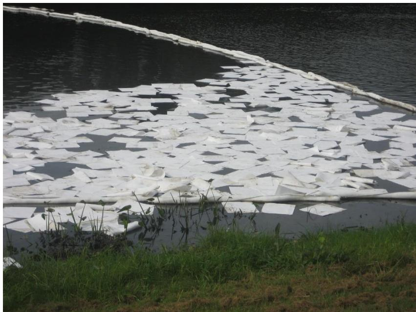
**Slika 2-4.** Sintetski organski hidrofobni adsorbensi u obliku krpa za odstranjivanje izljeva ugljikovodika iz okoliša ([www.chemtexllc.com](http://www.chemtexllc.com))
