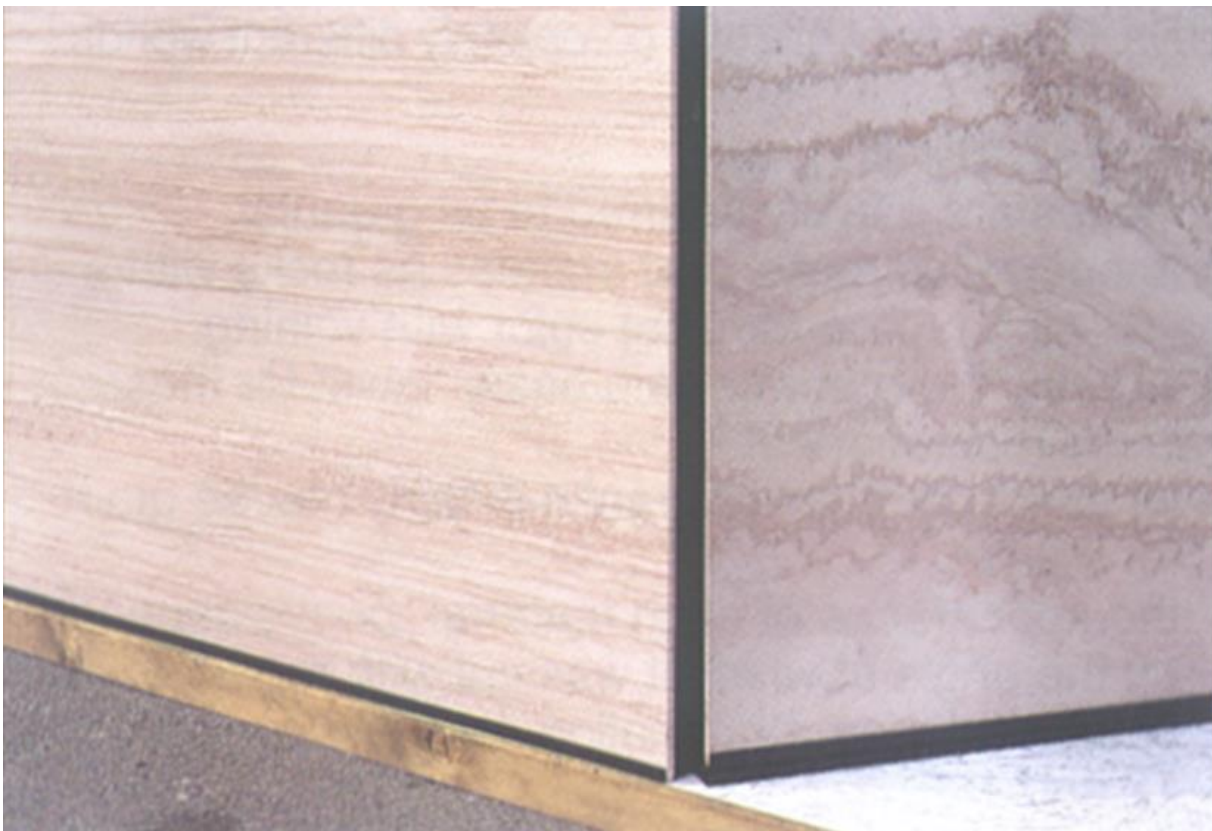
Slika 4-3 Razlika u izgledu kamena u odnosu na smjer piljenja (Dunda, 2006)
