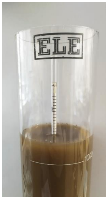
Slika 3.4 Očitavanje gustoće na areometru (foto: Gavrić)
