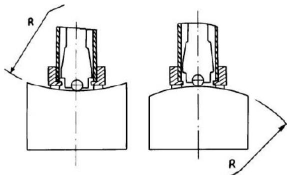
Slika 3-3 Radius zakrivljenosti površine R koja se ispituje (prema TIME Ltd, 2020)
