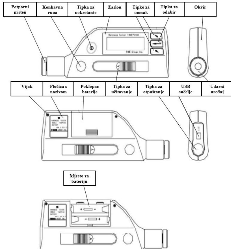
Slika 3-2 Struktura Leeb uređaja Time 5100 (prema TIME Ltd, 2020)
