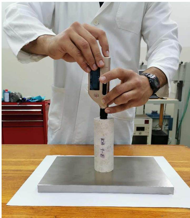
Slika 3-8 Ispitivanje Leeb tvrdoće na uzorku vapnenca KA 1-8
