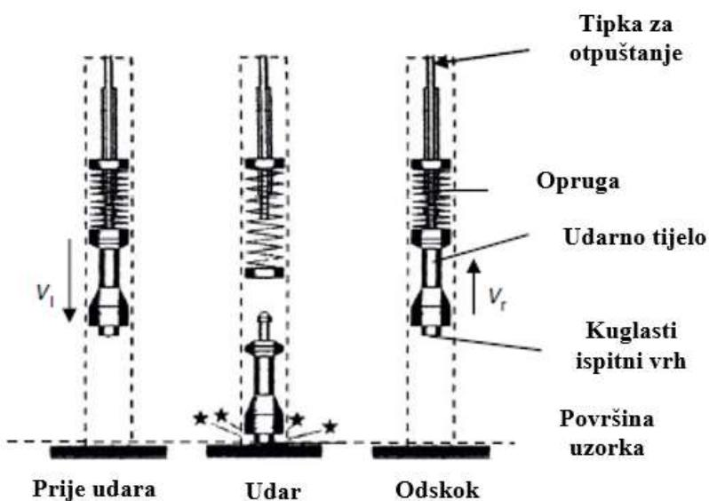
Slika 2-1 Shematski prikaz Leeb uređaja (Anan, 1977)
