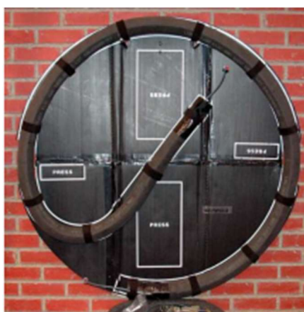
Slika 4-12. Kumulativni rezač za probijanje otvora u zidu (Bohanek, 2013)
