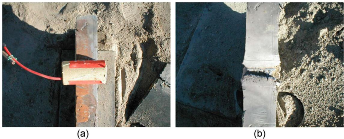
Slika 3-5. Linijski kumulativni naboj: a) kumulativni rezač i b) njegov učinak na čeliku (Duan et al., 2017)
