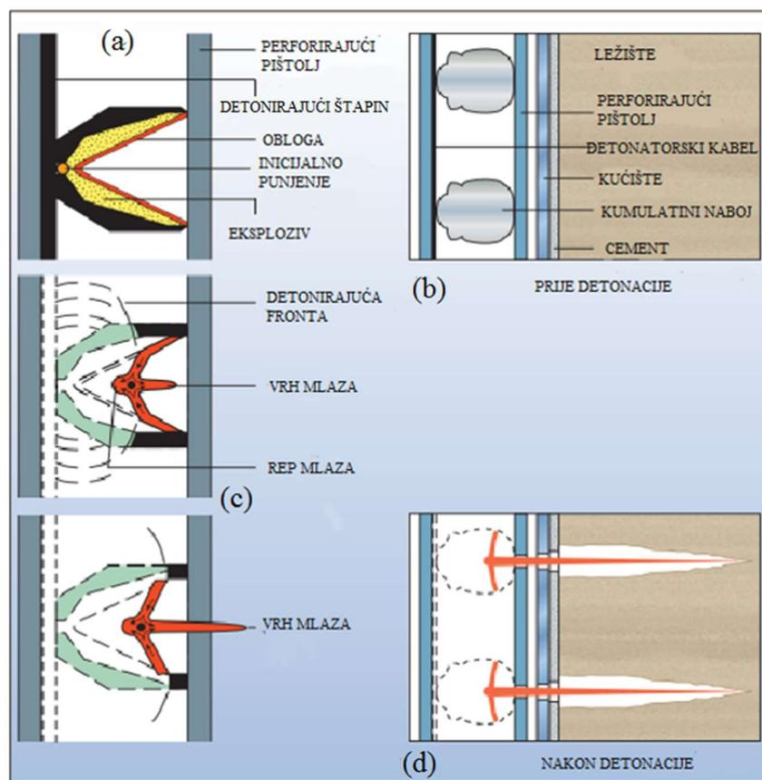
Slika 4-5. Proces perforacije i detonacija kumulativnog naboja (Smithson, 2012)
