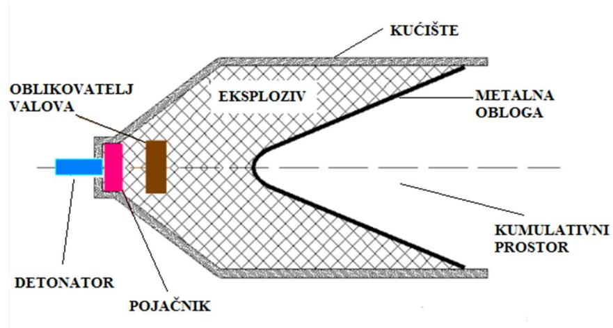
Slika 3-1. Shematski prikaz poprečnog presjeka kumulativnog eksplozivnog naboja (Elshenawy, 2012)
