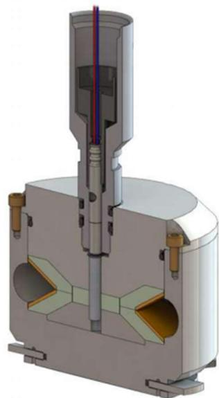
Slika 4-7. Linijski kumulativni rezač za rezanje bušutinskih cijevi (Bohanek, 2013)
