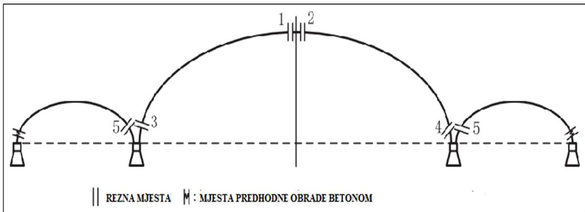
Slika 4-1. Plan rušenja čeličnog lučnog mosta Qinghemenu (Duan et al., 2017)
