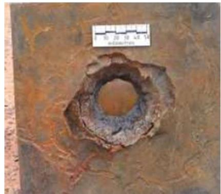
**Slika 3-9.** Učinak konusnog kumulativnog eksplozivnog naboja na meti nakon detonacije (Applied Explosives, 2008).
