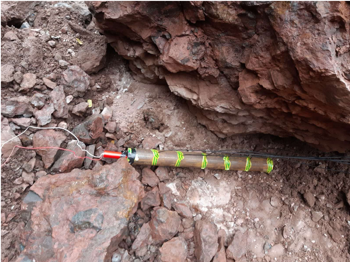
Slika 5-4. Prikaz eksplozivnog naboja u čeličnoj cijevi i optičkim vlaknima kao senzorima
