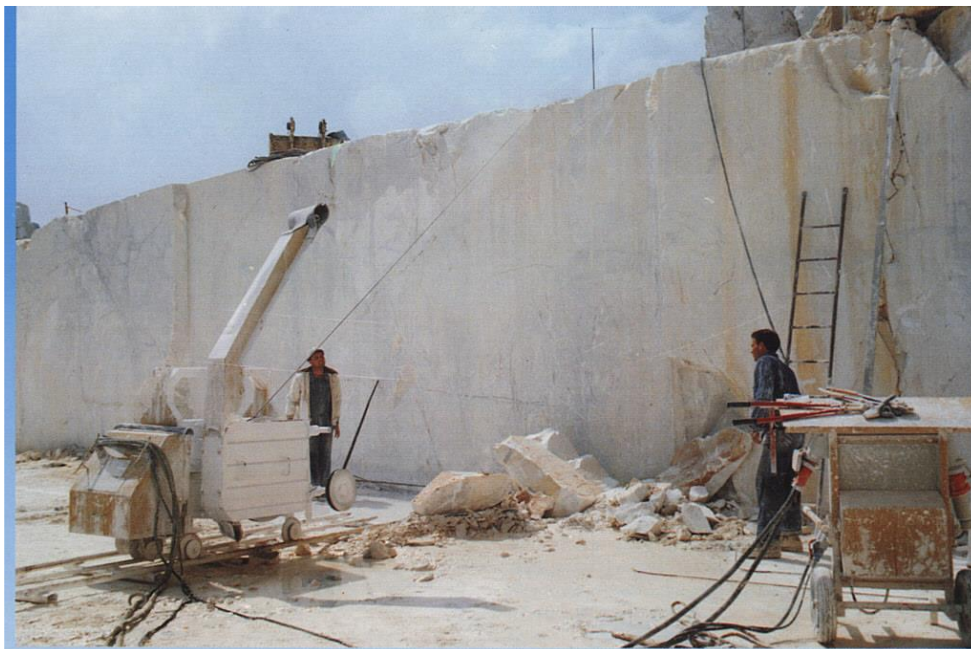
Slika 3-2: Automatska regulacija napinjanja žice (Dunda i Kujundžić, 2003.)
