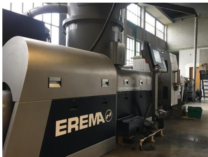
**Slika 2-4.** Stroj za granuliranje tvrtke Erema (Pos-plast, 2021)
