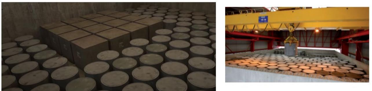
**Slika 2.8.** Način pakiranja otpada u čelične bačve ili betonske/čelične kocke i način slaganja u betonske kasete (Andra, Nuclear waste in France).
