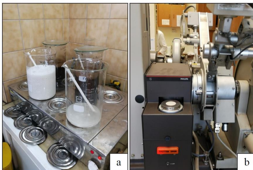
Slika 7- 11 Fotografije prikazuju: a) burna reakcija vapnenaca prilikom otapanja u puferu, b) Philipsov difraktometar.
