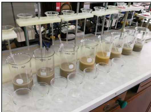
Slika 7- 12 Otapanje gipsa u uzorcima boksita.
