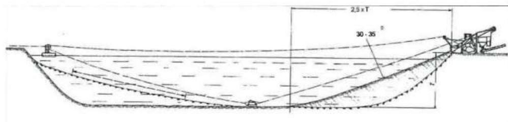
Slika 3.2. Poprečni presjek eksploracije građevnog pijeska i šljunka bagerom skreperom
