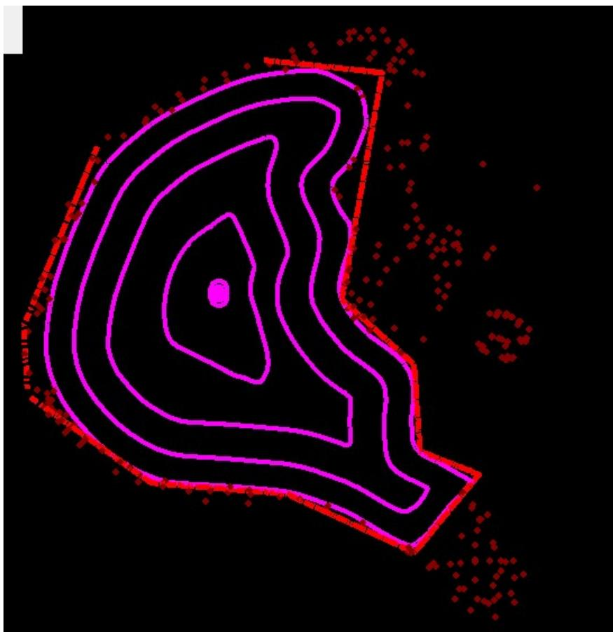
Slika 5.17. Elementi koji ulaze u triangulaciju (prenamjena)
