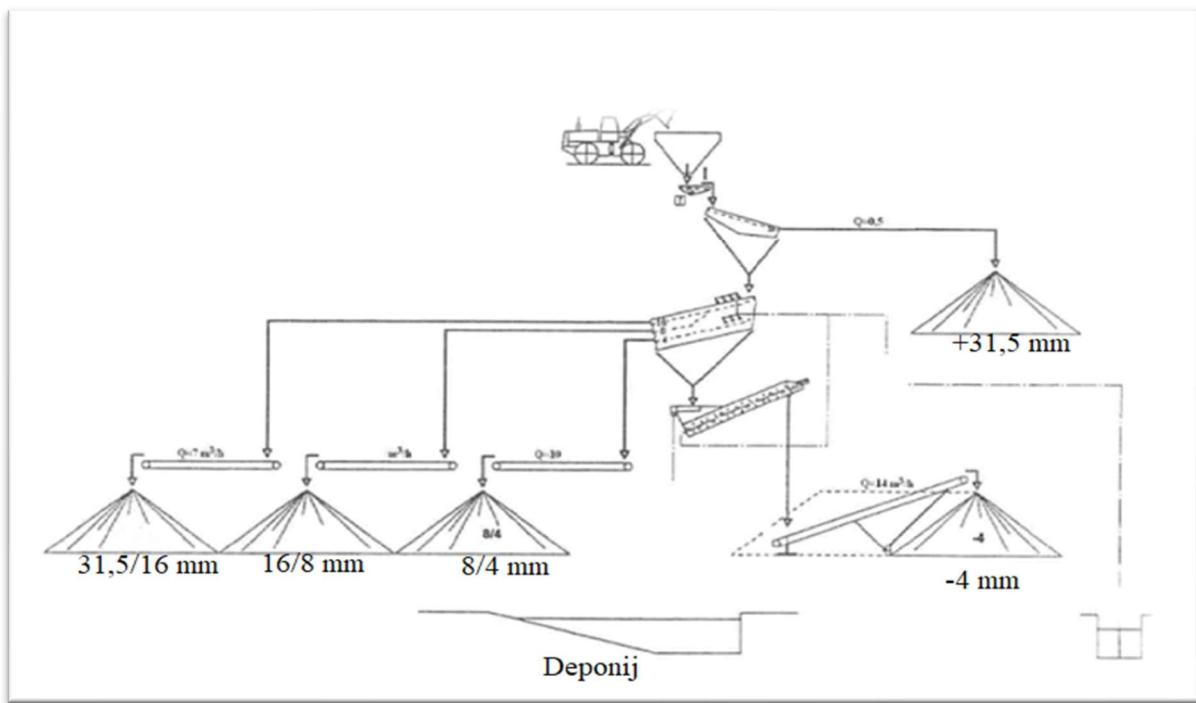
Slika 3.4. Tehnološka shema klasiranja šljunka i pijeska
