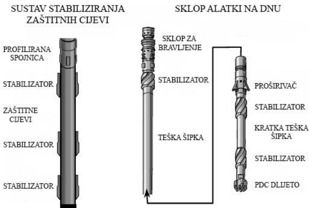
Slika 3-3. Sklop za kontrolu otklona kanala (Warren et al., 2003)
