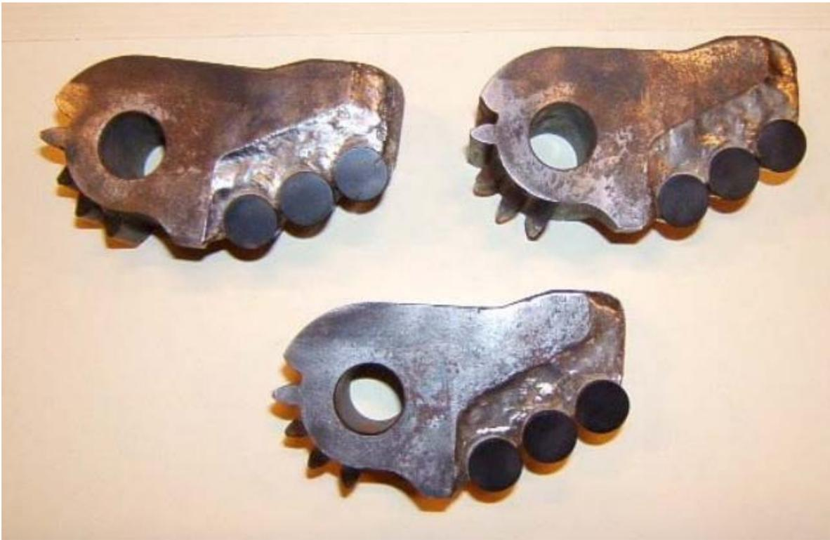
Slika 4-6. Rezni elementi proširivača nakon upotrebe tijekom bušenja dionice kanala bušotine B-16A (Bourassa et al., 2008)
