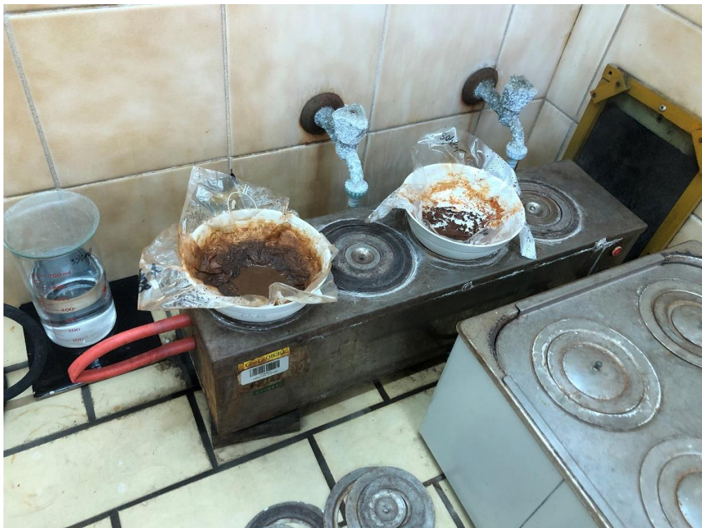
Slika 3.20. Sušenje uzoraka frakcije <2 \mu\text{m} (foto:Fran Vrdoljak)
