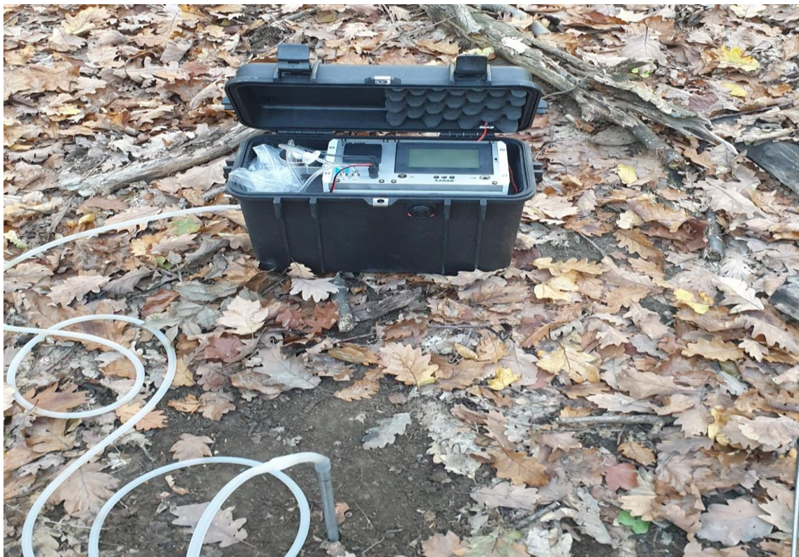
Slika 10. Fotografija mjerenja koncentracija radona i torona instrumentom SARAD RTM 2200 SG
