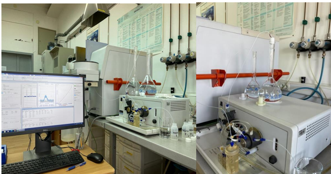
Slika 6–8. Mjerenje As hidridnom tehnikom na AAS Perkins Elmer AAAnalyst 700.
