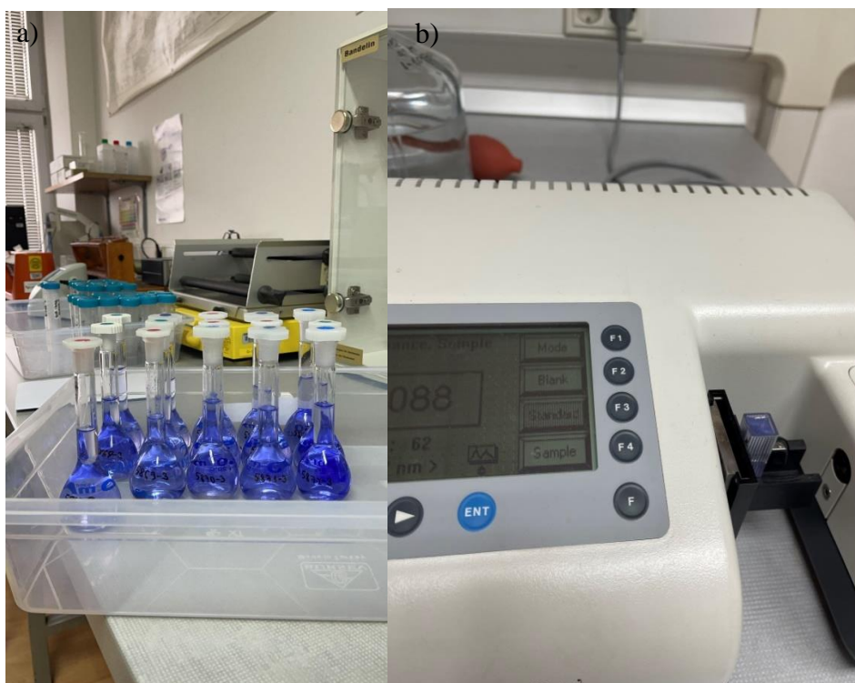
Slika 6–9. a) Pripremljeni uzorci za analizu kapaciteta kationske zamjene metodom Cu–trien, b) Zeiss SPEKOL 1100 spektrofotometar.
