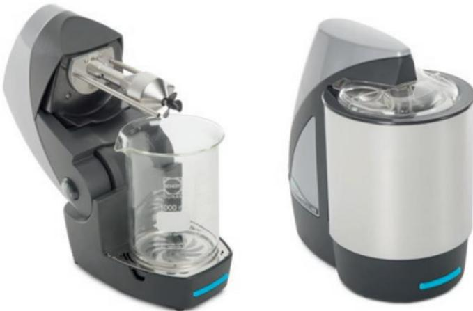
**Slika 3-10.** Nastavci Hydro EV (lijevo) i Hydro MV (desno)
