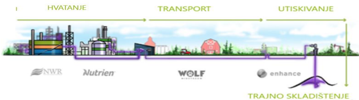
Slika 3-2. CCUS projekt u Alberti (prema The ACTL System, 2020)
