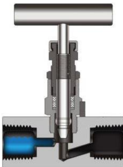
Slika 6-4. Prikaz igličastog ventila ( https://megadepot.com , 2022)
