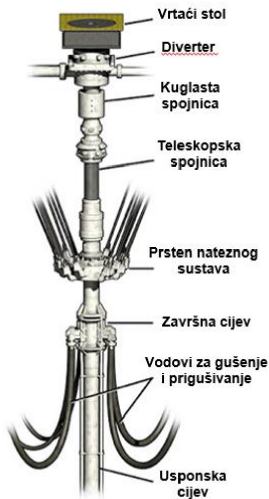
Slika 7-2. Prikaz položaja divertera kod sustava s nizom usponskih cijevi (Krištafor, 2021)
