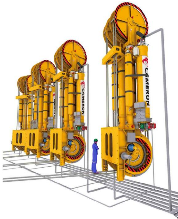
Slika 6-1. Prikaz komponenata nateznog sustava usponskih cijevi (Laik, 2018)
