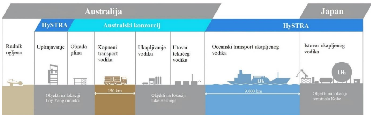
Slika 4-5. Shema HESC projekta (Kawasaki Heavy Industries, Ltd, 2019)
