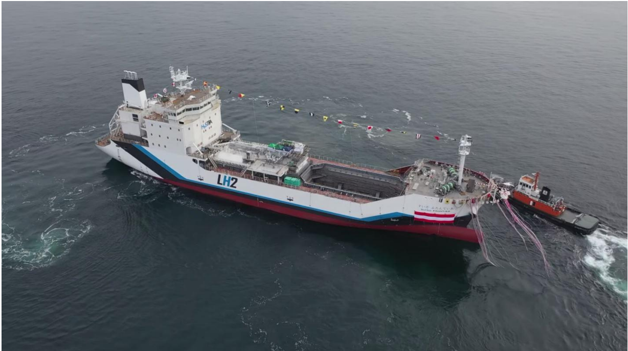
Slika 4-3. „Suiso Feontier“, brod za transport tekućeg vodika (Kawasaki Heavy Industries, Ltd, 2019)
